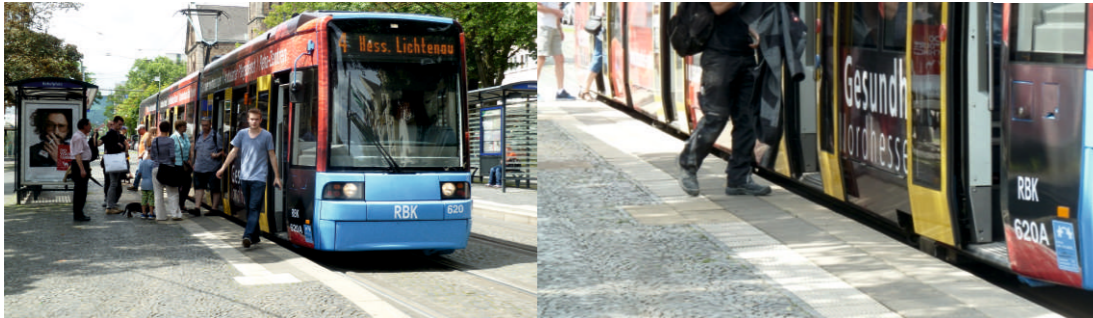
Niederflurstraßenbahn in Kassel. Die Bahnsteige sind so hoch wie ein normaler Bordstein. Der Einstieg ist ebenerdig möglich.
